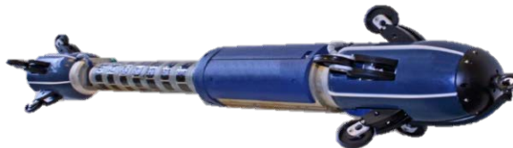
Рис. 1 ВТИП методом акустического резонанса
