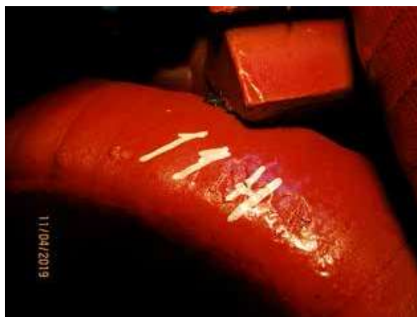
Рис. 8. Смятие и истирание изоляции стержня 16Н со стороны возбuditеля межслоевой колодкой
